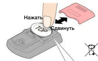
\* Надавите на верхний край водостойкой внутренней крышки, чтобы снять её. Установите крышку обратно стороной TOP вверх.
