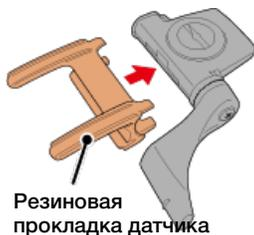
(3) В соответствии с рисунком, на время прикрепите датчик к левому нижнему перу заднего треугольника при помощи нейлоновых стяжек.
