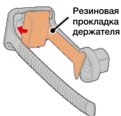
3. Оберните ремешок вокруг выноса и затяните гайку для фиксации.
